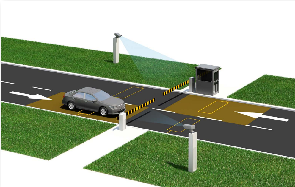
Рисунок 11 — Размещение камеры на контрольно-пропускном пункте (используется шлагбаум)
