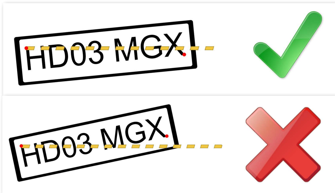
Рисунок 10 — Определение допустимого крена однострочного номера («правило одной линии»)
