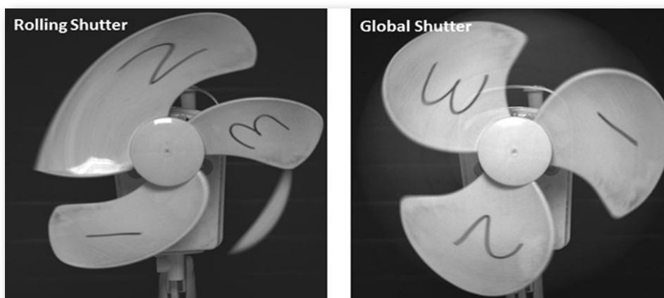
Рисунок 4 — Сравнение фотоснимков, полученных при съемке движущихся предметов (с полнокадровым и построчным переносом) 3
